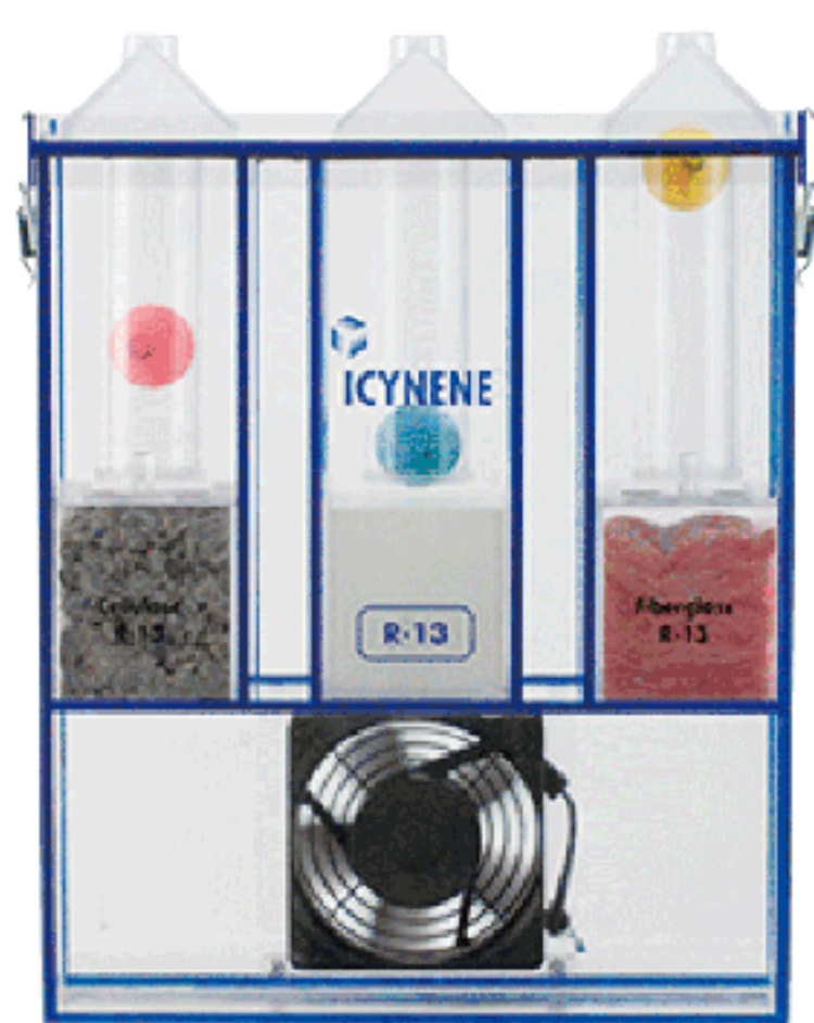
※空気の透過を示す実験 左からセルロース、アイシネン、 グラスウール
