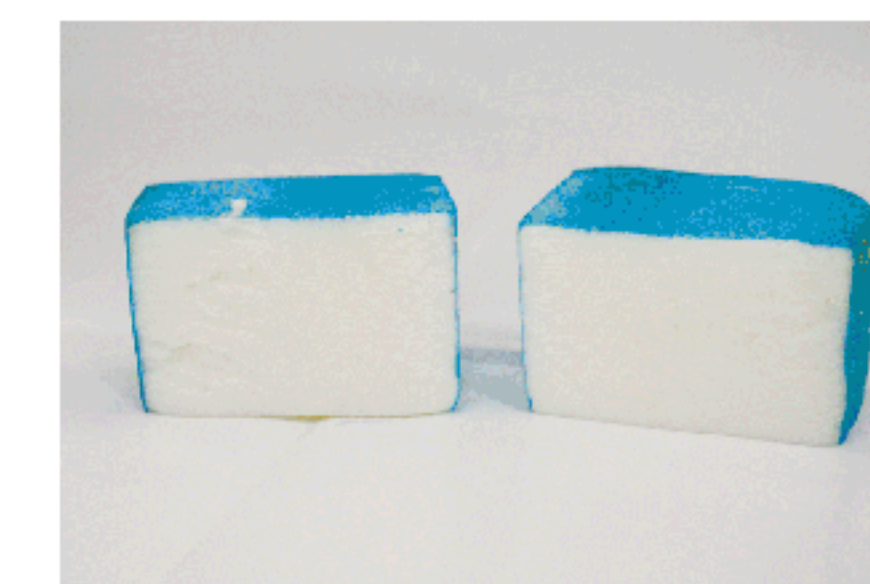
試験開始から96時間後に水中から取り出した試験体 (青く着色された部分が吸水箇所)
